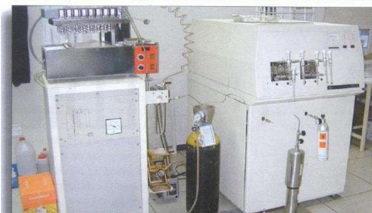
Espectrómetro de masas de fase gaseosa y de doble entrada utilizado para la determinación de abundancias isotópicas de isótopos pesados de Hidrógeno, carbono, oxígeno, nitrógeno y azufre.
