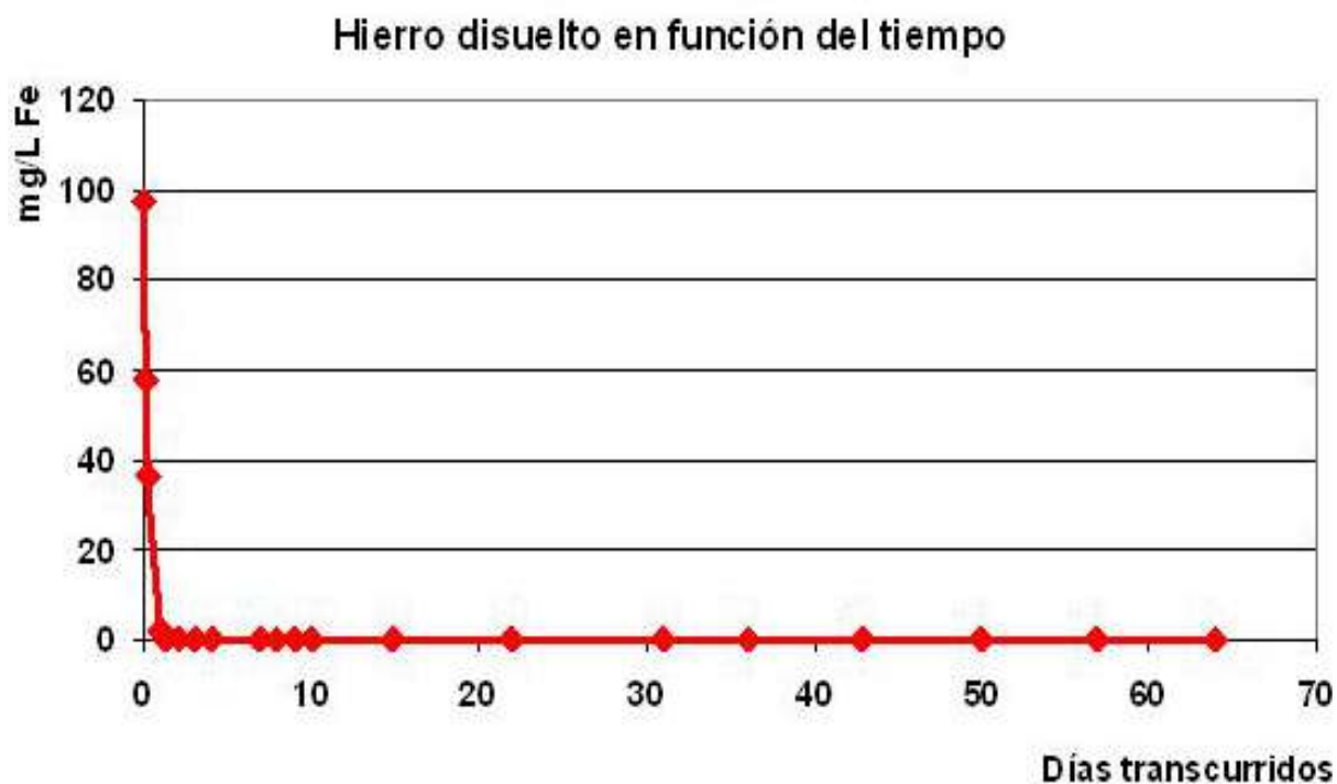
Figura 12. Ensayo in situ de disminución del hierro por efecto de la dolomía de Reocin
