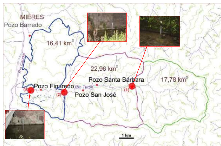
Figura 4. Izq.: Cuenca del río Turón considerando el área de afección de las labores mineras existentes en su valle; se indican los puntos de aforo (con escalas limnimétricas) y las subcuencas asociadas. Dcha.: Representación conjunta de los hidrogramas de las tres secciones de aforo.
