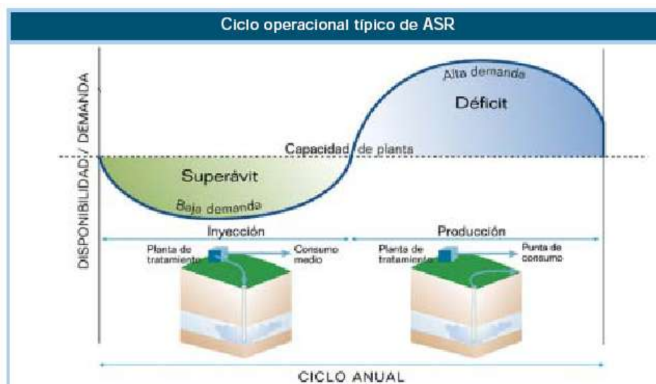
Figura 4. Ciclo operacional, inyectando en periodos de superávit y bombeando el agua del acuífero periodos de déficit.
