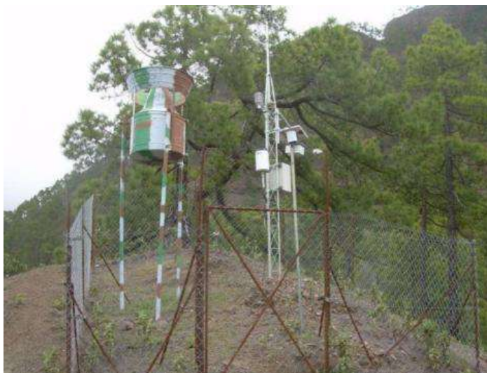
Ilustración 6.4; Estación meteorológica en el Parque Nacional de Taburiente, en La Palma (Santamarta J, 2008)
