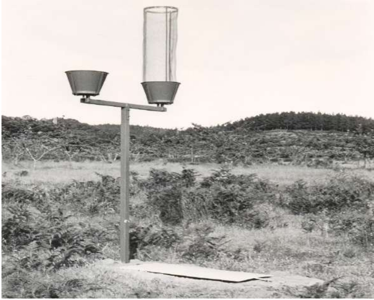
Figura 22.3; Pluviómetros totalizadores y captaniebla cilíndricos fabricados en las instalaciones del ICONA. (Santana, LM)
