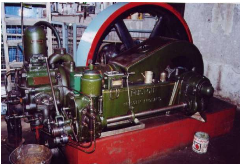
Figura 12.8; Motor inglés Ruston de 30 CV para elevar agua con bombas de pistón en un pozo de Valsequillo (Gran Canaria). (Suárez F, 2002).
