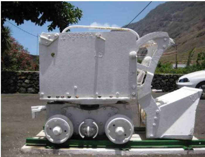
Figura 10.5; Máquina vagoneta con pala para extracción de escombros (Santamarta JC, 2011)
