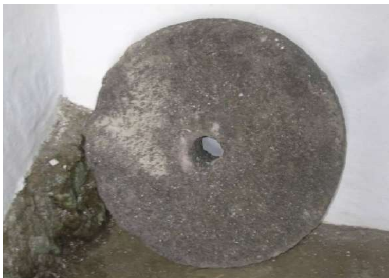
Figura 18.2; Piedra molinera de basalto en molino hidráulico en las isla de Terceira (Azores). (Santamarta JC, 2011)
