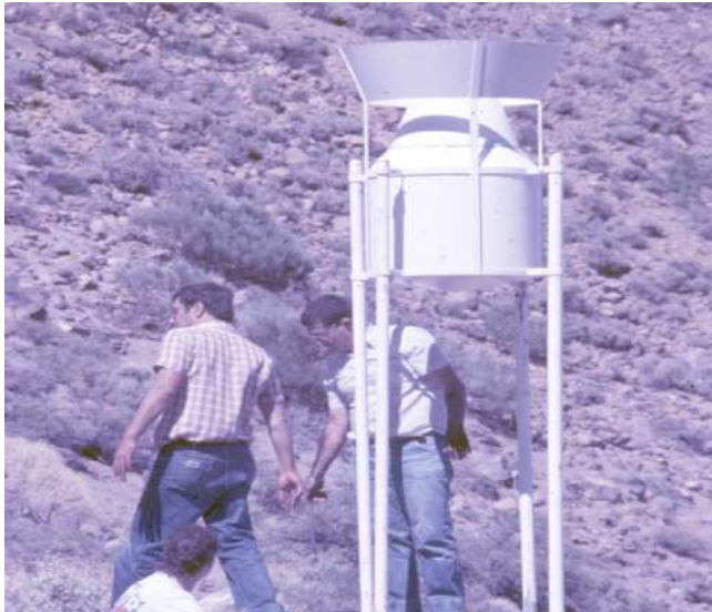
Figura 22.2; Pluviómetro Hellman totalizador de montaña. (Santana LM)
