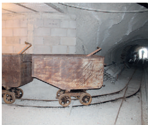
Figura A.5.- Anchurón para cambio de maquinaria y vagones.
