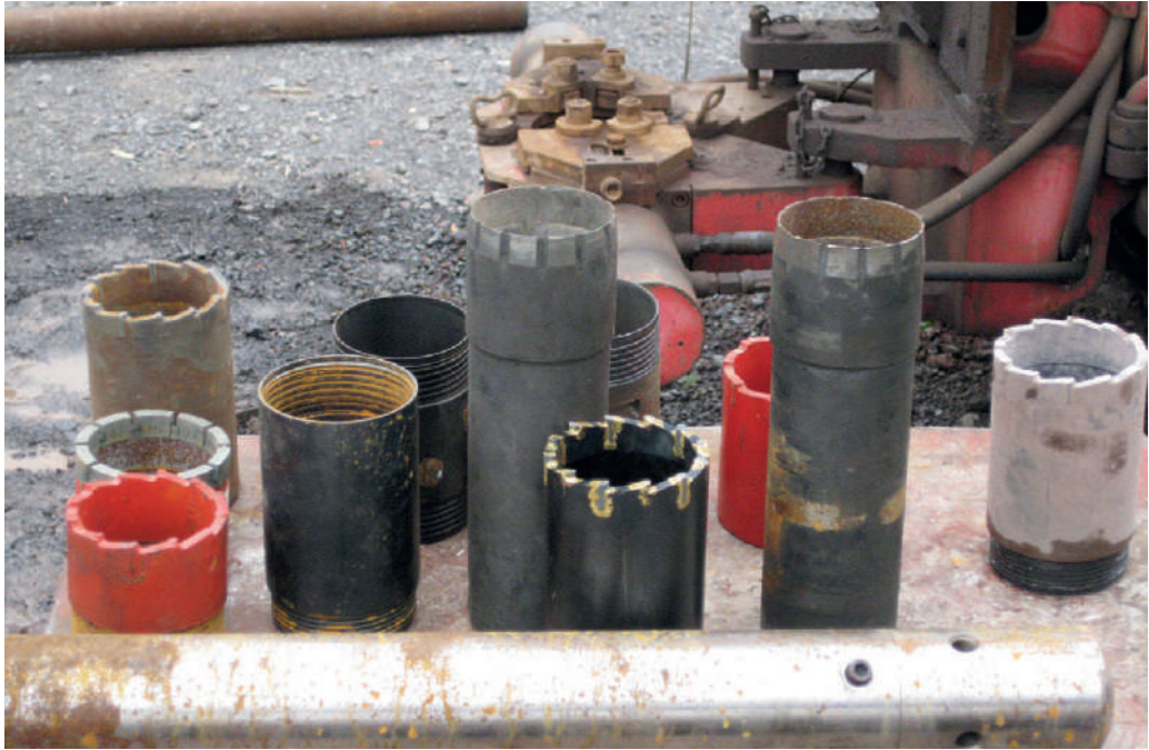
Figura 4.7.- Diferentes coronas para la ejecución del sondeo.
