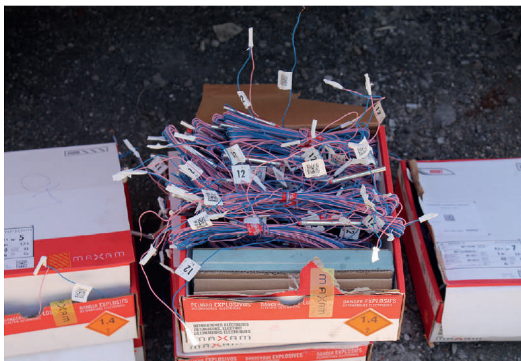
Figura 6.1.- Detonadores para uso en galerías de agua.
