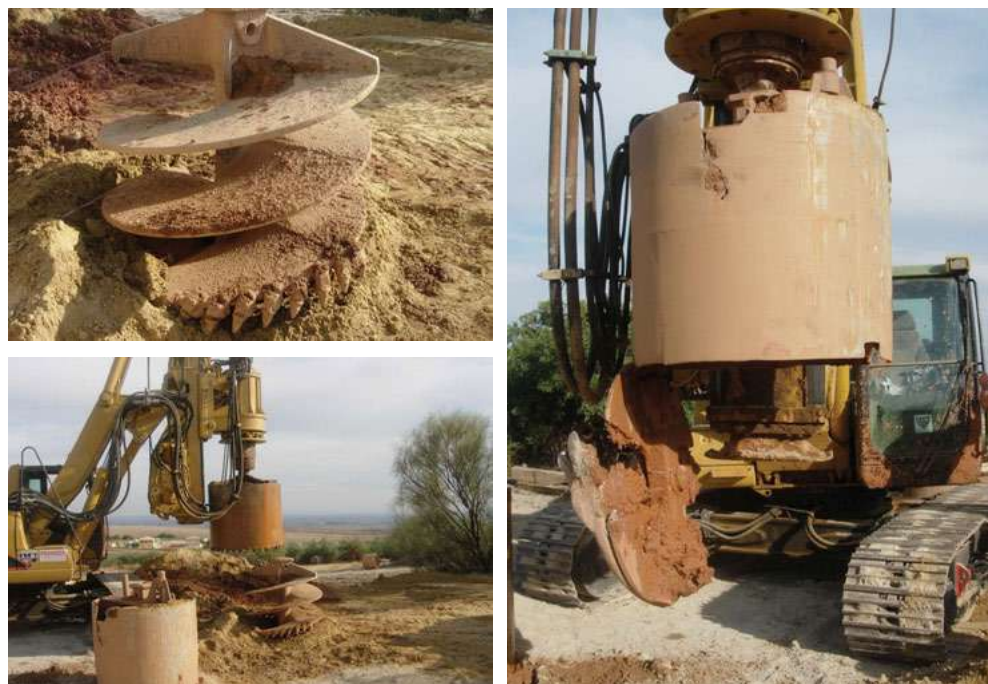
Figura 4.2. Máquina de perforar de hélices, que permite realizar pozos de hasta unos 30 m de profundidad en terrenos sueltos (blandos) con diámetros grandes de perforación y entubación con anillos de hormigón.
