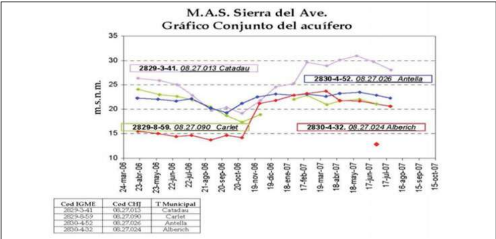
Figura 2.12. Representación gráfica de varios piezómetros indicando la recuperación de un acuífero después de la explotación de pozos de sequía.
