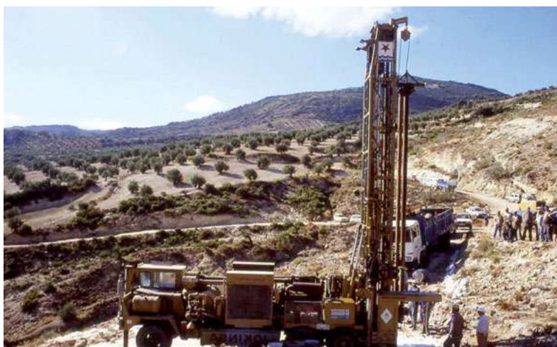
Figura 4.3. Máquina de perforación a rotopercusión.
