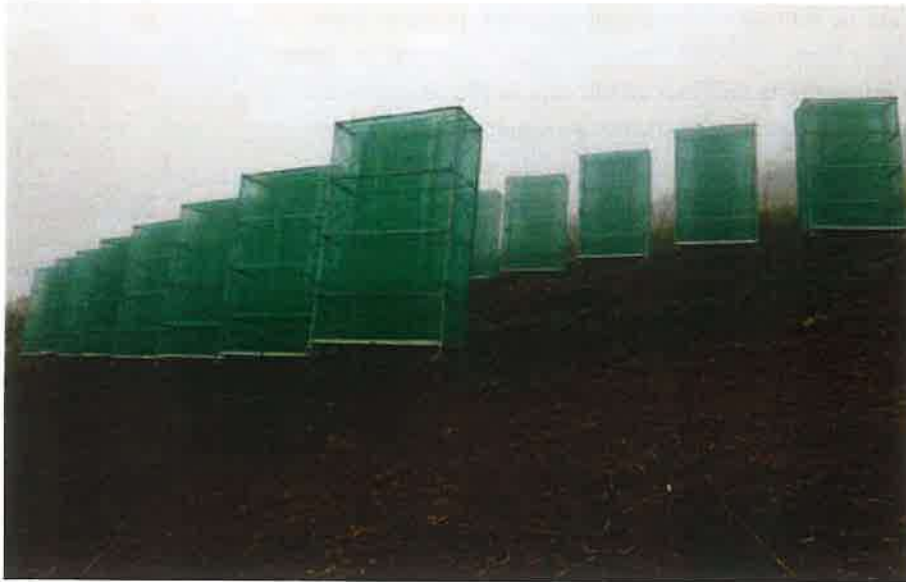
Figura 2.9. Captadores de lluvia horizontal para su uso en restauración forestal
